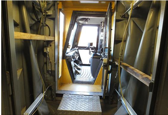
Sondermüll-Deponie Kölliken von der Firma Eberhard selbst geplant und teilweise auch selbst erstellt worden. Nebenstehend der luftdicht abgeschlossene Zugang von der Aussenwelt in ein Abbaufahrzeug innerhalb der gedeckten, abgeschlossenen Depoie. Auch das Fahrzeug selbst ist mit Sauerstoffversorgung ausgerüstet, damit es autark in der Schadstoff belasteten Halle
