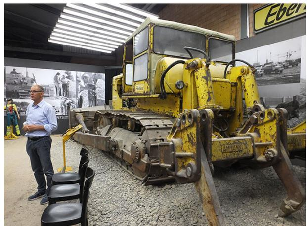
das Bild mit Regula. Bei diesem Caterpillar erfolgt das Heben der Schaufel noch mit Drahtseilen.
